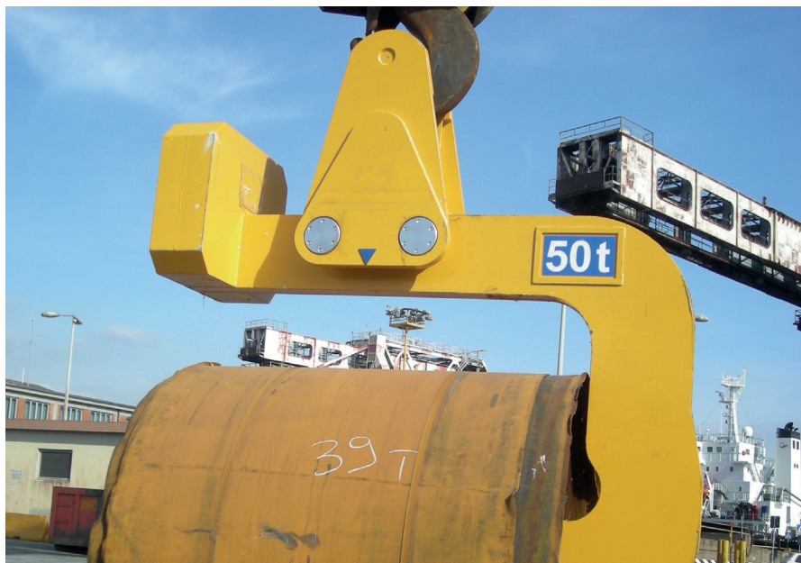
GANCIO A "C" PER TUBI / PIPE C-HOOK PORTATA / CAPACITY 50.000 Kg
