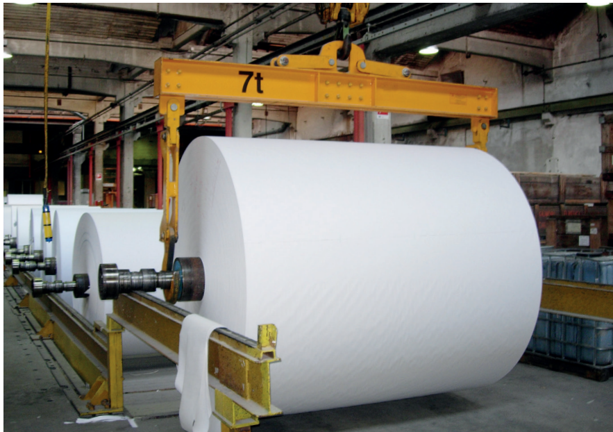
BILANCINO PER CARTIERE / PAPER LIFTING BEAM PORTATA / CAPACITY 7.000 Kg
