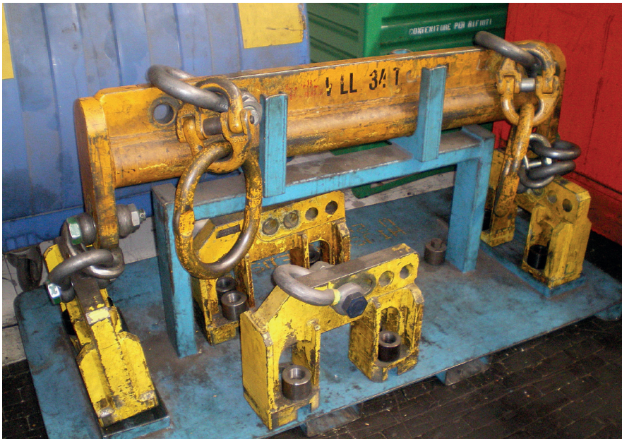
BILANCINO SOLLEVAMENTO MOTORI / ENGINE LIFTING BEAM PORTATA / CAPACITY 34.000 Kg
