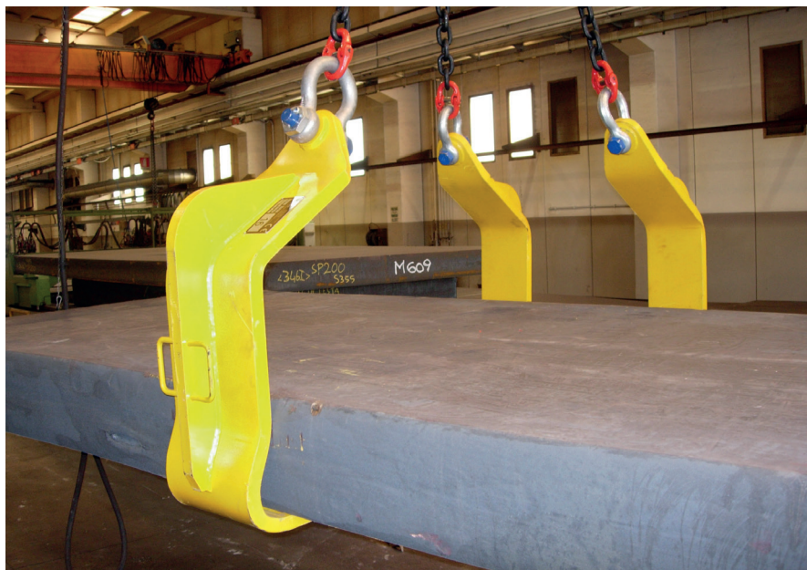
STAFFE DI SOLLEVAMENTO / LIFTING FORK PORTATA / CAPACITY 20.00 Kg
