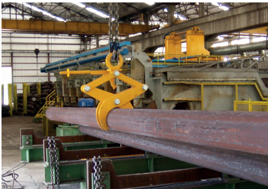
PINZA DI SOLLEVAMENTO MATASSE / FOIL ROLLS LIFTING TONG PORTATA / CAPACITY 2.500 Kg
