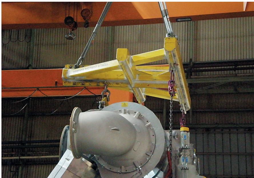
BILANCINO SOLLEVAMENTO MOTORI / ENGINE LIFTING BEAM PORTATA / CAPACITY 21.000 Kg
