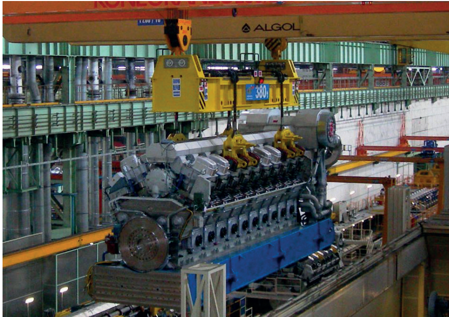
BILANCINO PER MOTORI / ENGINE LIFTING BEAM PORTATA / CAPACITY 370.000 Kg
